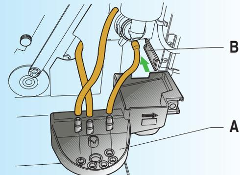
**Montar a chapa de apoio dos injetores:**
